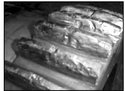
Laminador a frio com sabão de bissulfeto de molibdênio típico depois de um ano.
