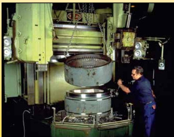
Um anel de engrenagem danificado é retirado de uma luva de rolamento de fuso. O custo de reparo normalmente é a metade do custo de substituição
