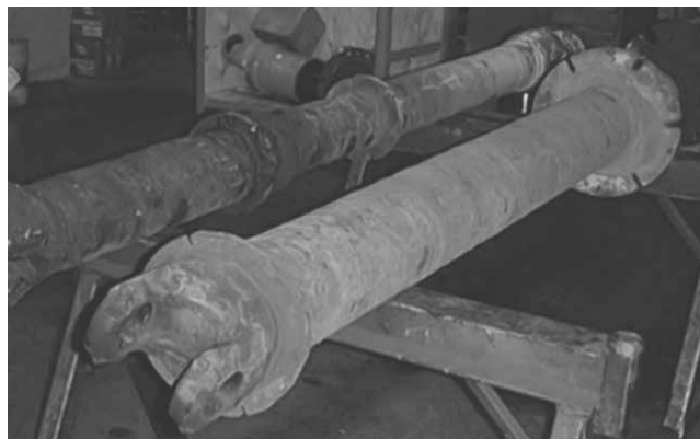
Uma junta universal, conforme foi recebida de um cliente em nosso centro de serviços, para inspeção e reforma
