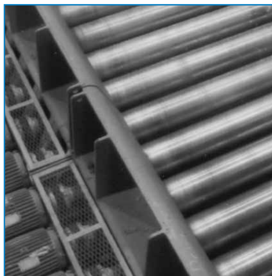
Acoplamento ELASTOMERIC™ para mesa de saída (mostrado sob a proteção) em uma grande usina siderúrgica de tiras de aço a quente
