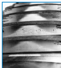
Engrenamento retificado com verificação de contato a 3° 90 a 100% do dente da engrenagem em contato. Excelente acabamento do flanco do dente da engrenagem
