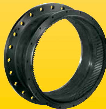
Um anel de engrenagem danificado é retirado de uma luva de rolamento de fuso. O custo de reparo normalmente é a metade do custo de substituição
