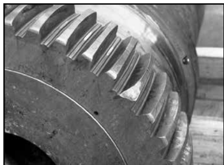
Ruptura da extremidade do dente devido ao desalinhamento elevado
